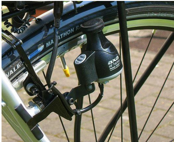
Abbildung 1 Ein einfacher Fahrrad-Dynamo. Oben sieht man das „Reibrad“, das im Dynamo einen kleinen Magneten bewegt. Der macht den Strom fürs Licht.
